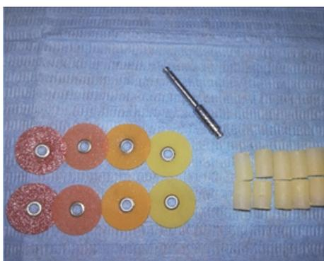
**Fig. 3.** Discos de óxido de aluminio (3MTM Sof-Lex™) utilizados para el pulido de los especímenes.
