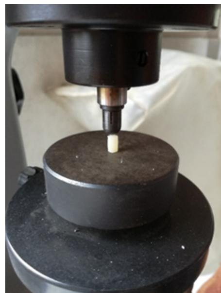
**Fig. 4.** Medición de dureza superficial utilizando durómetro Rockwell Hardness Tester.
