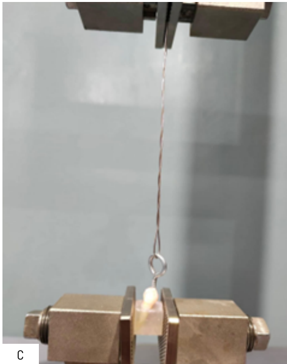
Figura 2. Instrumentos para la prueba de tracción. A. Máquina de ensayos universal, B. Montaje de la muestra, C. Muestra después de la prueba
